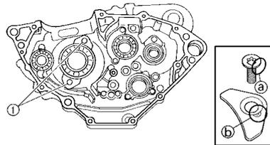
**INSTALLING THE CRANKSHAFT**
